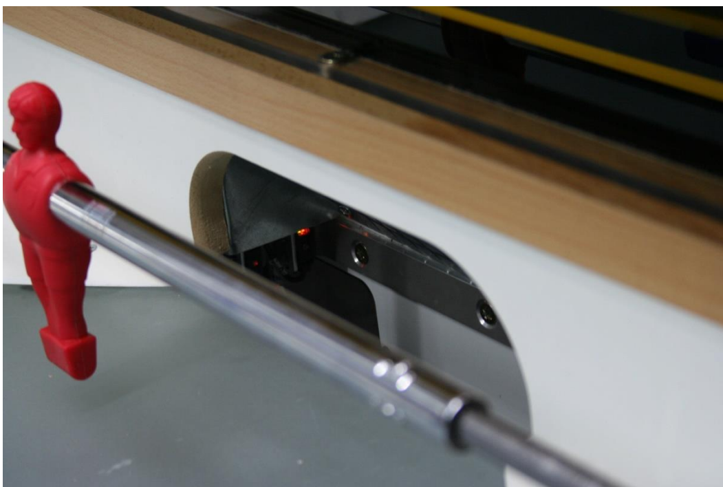
Obr. 15 Umiestnenie prvku pre snímanie gólov
